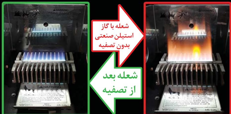
این سیستم بر اساس دو قسمت مجزا طراحی شده که قسمت بالایی آن یک کارتريج مصرفی می باشد. این کارتريج توان تصفیه یک گپسول گاز جوشکاری را داشته که شعله ای کاملاً آبی رنگ فراهم می آورد. قسمت پایینی سیستم به هیچ وجه نیاز به تغییر در کوتاه مدت را نداشته و هزینه ای به مصرف کننده تحمل نخواهد نمود. با استفاده از این سیستم در آنالیز عناصری مانند آرسنیک هیچ مشکلی نبوده و سیگنالی فاقد نویز خواهد داشت.
